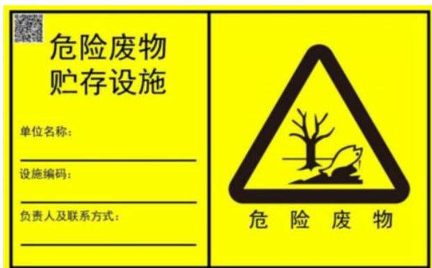
图 C.4 危险废物贮存设施标志样式示意图
